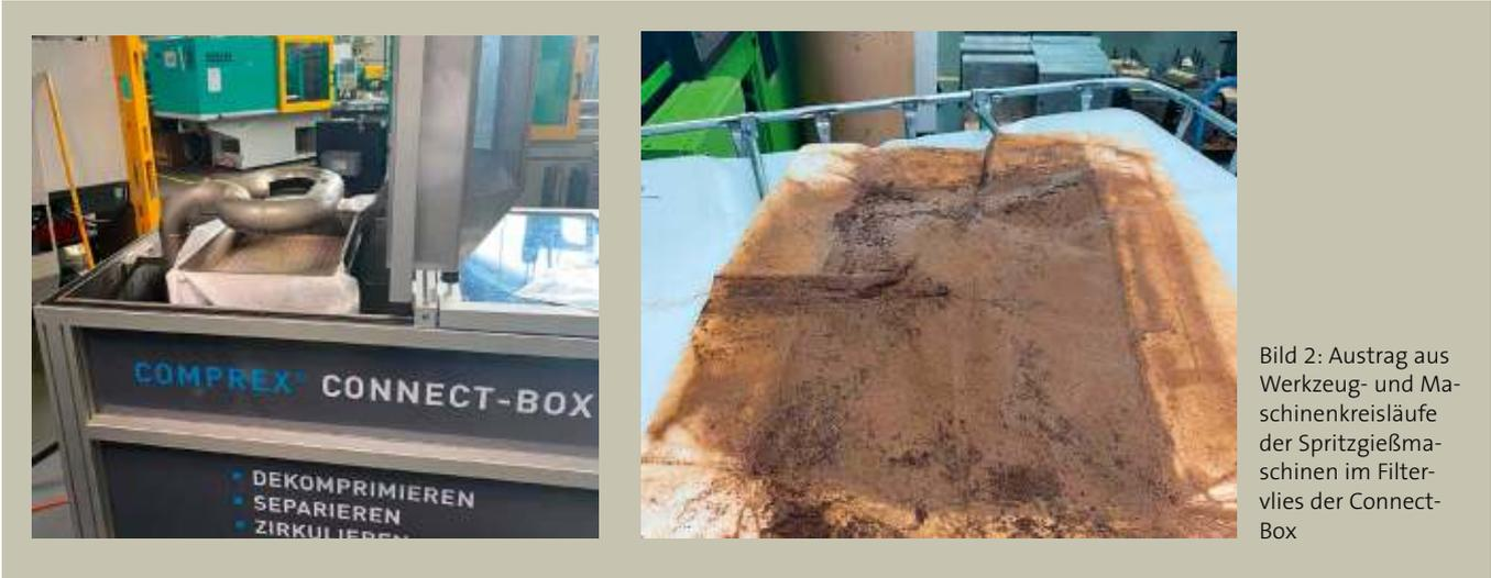
Bild 2: Austrag aus Werkzeug- und Maschinenkreisläufen der Spritzgießmaschinen im Filtervlies der Connect-Box
