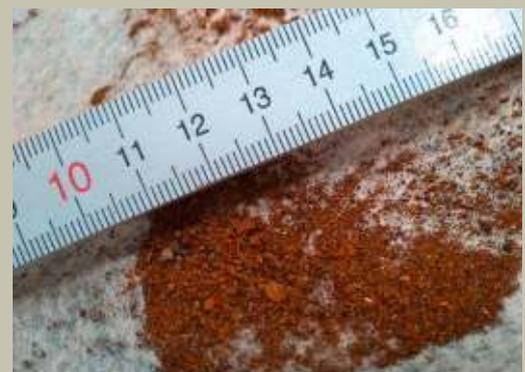
Bild 5: Ausgetragene Feststoffe aus Spritzgießwerkzeug auf Filtervlies
