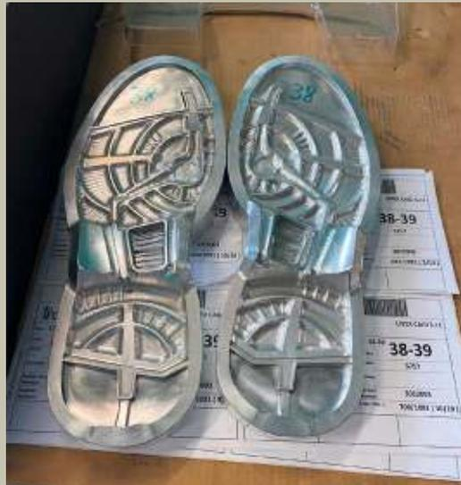
Bild 4: Beispiel für Spritzgießwerkzeug und Werkzeugeinsatz für Schuhsohle
