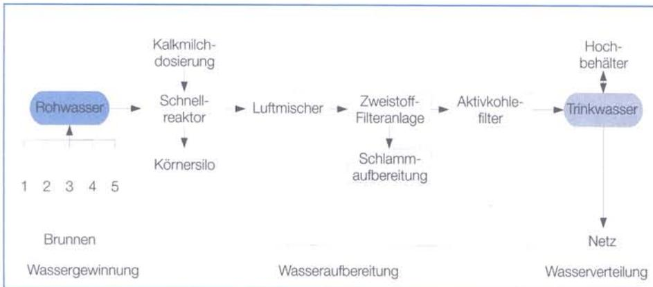
Abb. 4: Gewinnung und Aufbereitung des Rohwassers bei den Stadtwerken Ratingen
