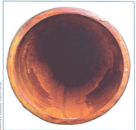
Abb. 13: Rohrabschnitt aus AZ-Leitung DN 350 nach erfolgreicher Impuls-Spülung
