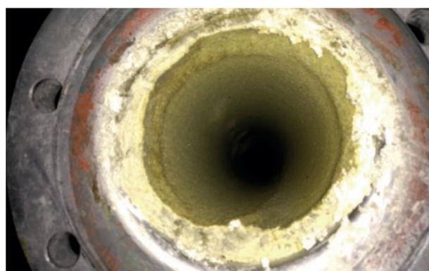
**Bild 3:** Ablagerungen in Schlammleitung einer Kläranlage und stationäre Complex-Anlage
