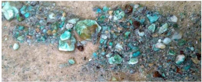
Abbildung 1: Partikelaustrag während der Comprex®-Reinigung
