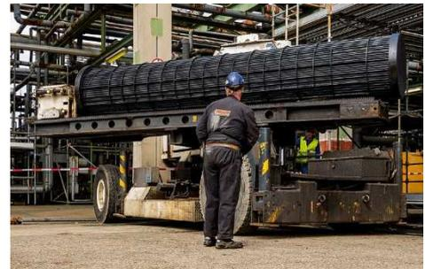
Abbildung 2: Rohrbündelwärmetauscher
