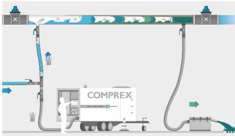
Abbildung 1: Schema des Comprex®-Verfahrens
