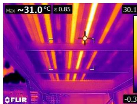
Abbildung 2: Wärmebild des Luftkühlers
