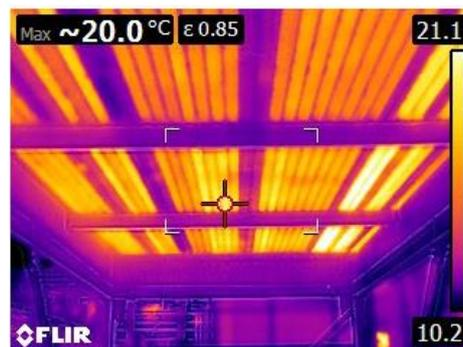
Abbildung 3: Wärmebild des Luftkühlers
